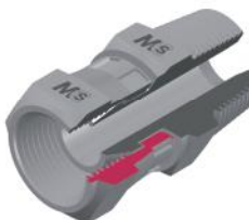
ADATTATORE MASCHIO/FEMMINA GIREVOLE Filetto Maschio NPT/Femmina NPSM MALE/SWIVEL FEMALE CONNECTOR WITH O'RING - S SERIES Male Thread NPT/Female Thread NPSM
